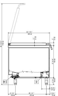
Drain ΕI Electrical inlet (power) Equipotential screw EQ Water inlet
